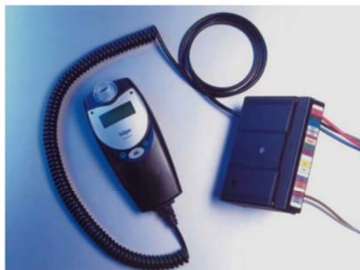
圖一、車輛點火自動鎖定裝置 左為呼氣分析儀，右為控制盒
