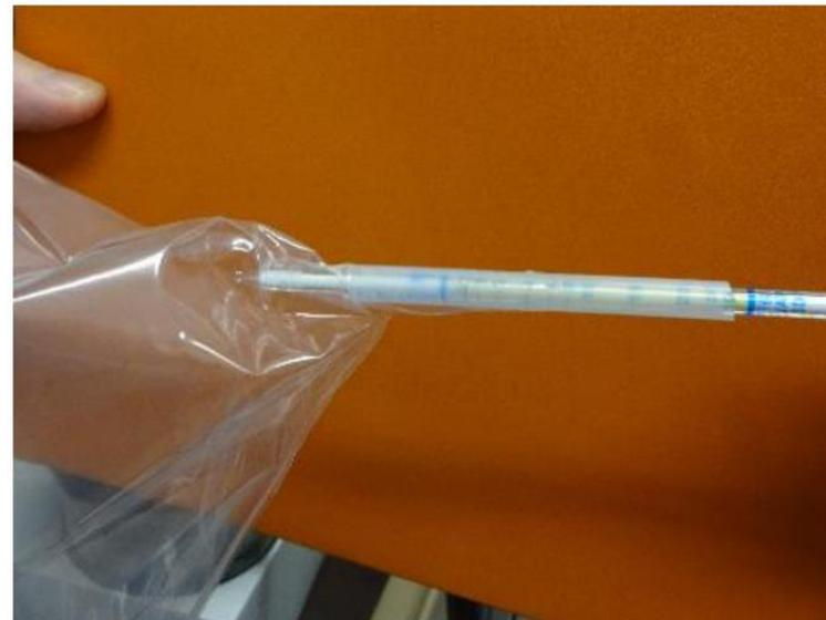
写真②：ガス採取の様子(検知管先端拡大)
